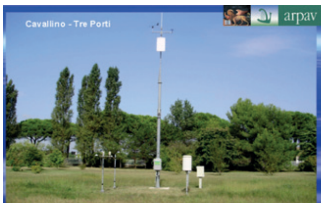
Fig. 11.1 - Esempio di stazione meteorologica: foto della stazione di Cavallino Treporti (fonte: ARPAV).
