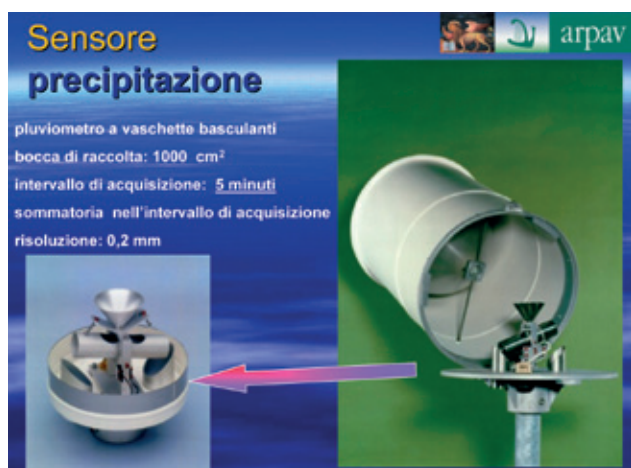
Fig. 11.3 - Sensori della stazione meteorologica: foto e caratteristiche del pluviometro per la misura della precipitazione (fonte: ARPAV).
