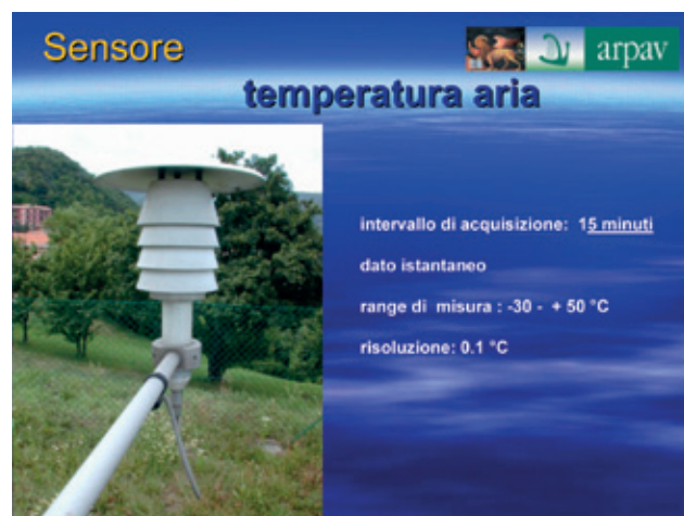
Fig. 11.31 - Sensori della stazione meteorologica: il termometro per la misura della temperatura dell'aria (fonte: ARPAV).
