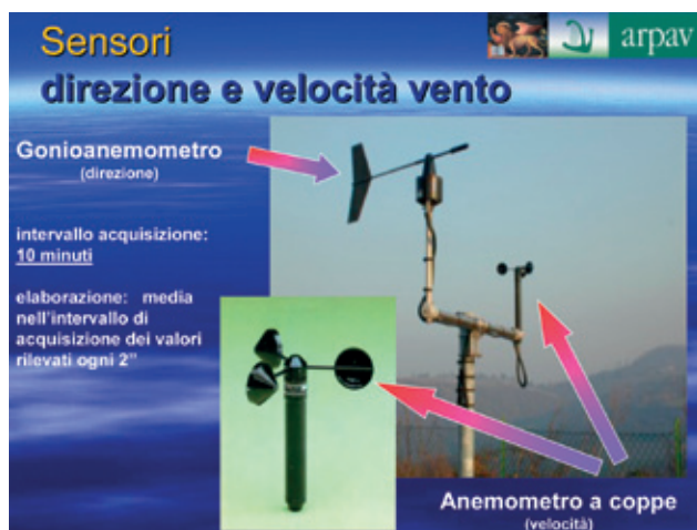
Fig. 11.42 - Sensori della stazione meteorologica: l'anemometro e l'anemoscopio per la misura della velocità e della direzione del vento.
