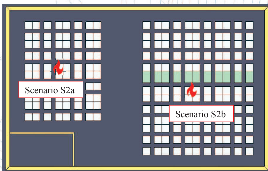
Fig. 27 – Collocazione in pianta dell'innesco termico per gli scenari d'incendio S2a e S2b all'interno del volume di calcolo della simulazione.
