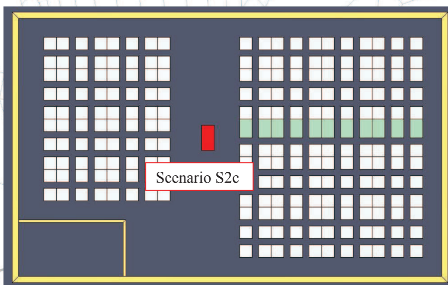
Fig. 28 – Collocazione in pianta dello scenario d'incendio S2c all'interno del volume di calcolo della simulazione.
