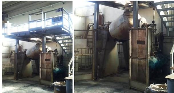
L'essiccatore è composto da un serbatoio in acciaio ed un corpo macchina con motore per imprimere l'effetto rotatorio. Il materiale solido ottenuto dal processo di centrifugazione negli idroestrattori, solitamente in cristalli, è inserito all'interno del serbatoio e fatto roteare a temperatura di circa 50 °C e sottovuoto per l'ottenimento di un prodotto secco.
