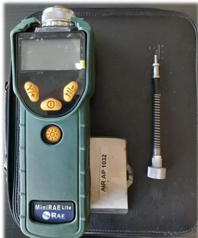
Le misure sono state svolte tramite analizzatore automatico a fotoionizzazione (*photometric ion detector*, PID) avente caratteristiche di misura conformi alle indicazioni della norma, sottoposto manutenzione e taratura periodica con standard di riferimento primari (si riporta il certificato di taratura del 2022 in allegato 1).
