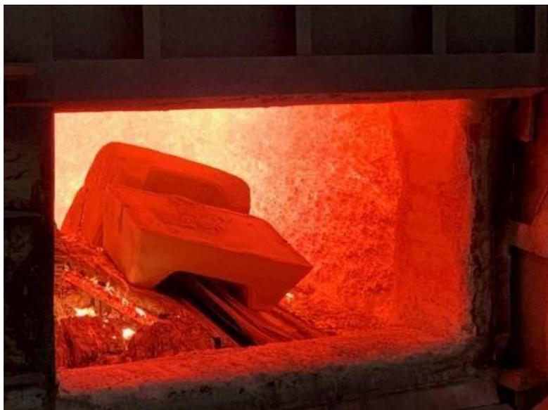
*Foto 2 – Alluminio durante il processo di fusione nel forno*
