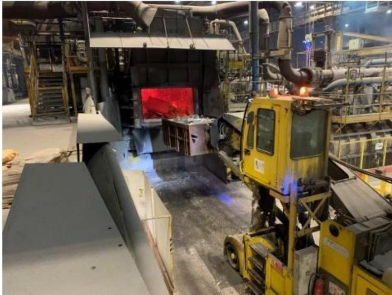
Il forno di fusione, mediante il calore sviluppato da bruciatori a metano, fonde l'alluminio fino a portarlo allo stato liquido ad una temperatura di circa 720°C .
