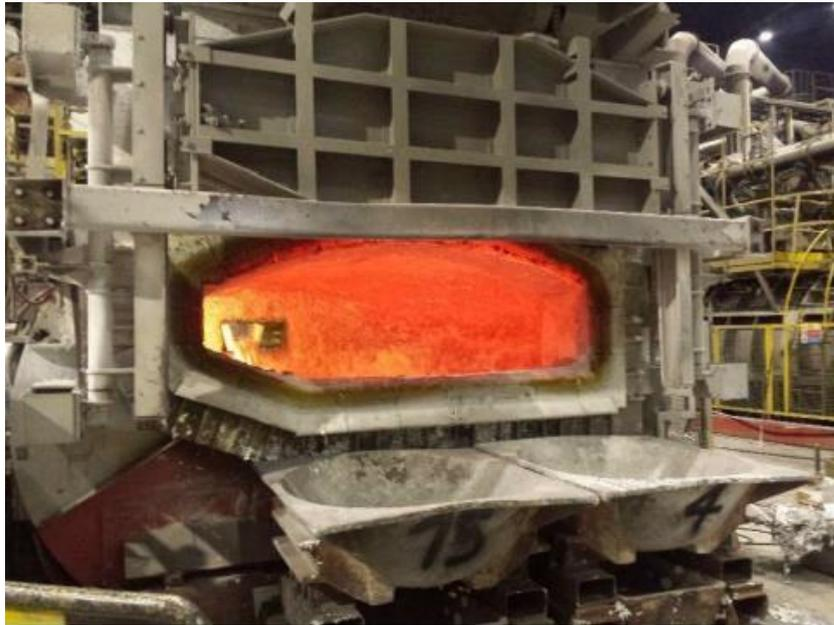
Nel forno di colata all'alluminio liquido vengono aggiunti gli elementi necessari (esempio: magnesio, manganese, silicio, rame, ecc.) per raggiungere la composizione della lega di alluminio richiesta dal cliente. Il forno di colata è alimentato da bruciatori che vanno a metano. Nel forno di colata viene mantenuta la temperatura atta a garantire il mantenimento del composto allo stato liquido.
