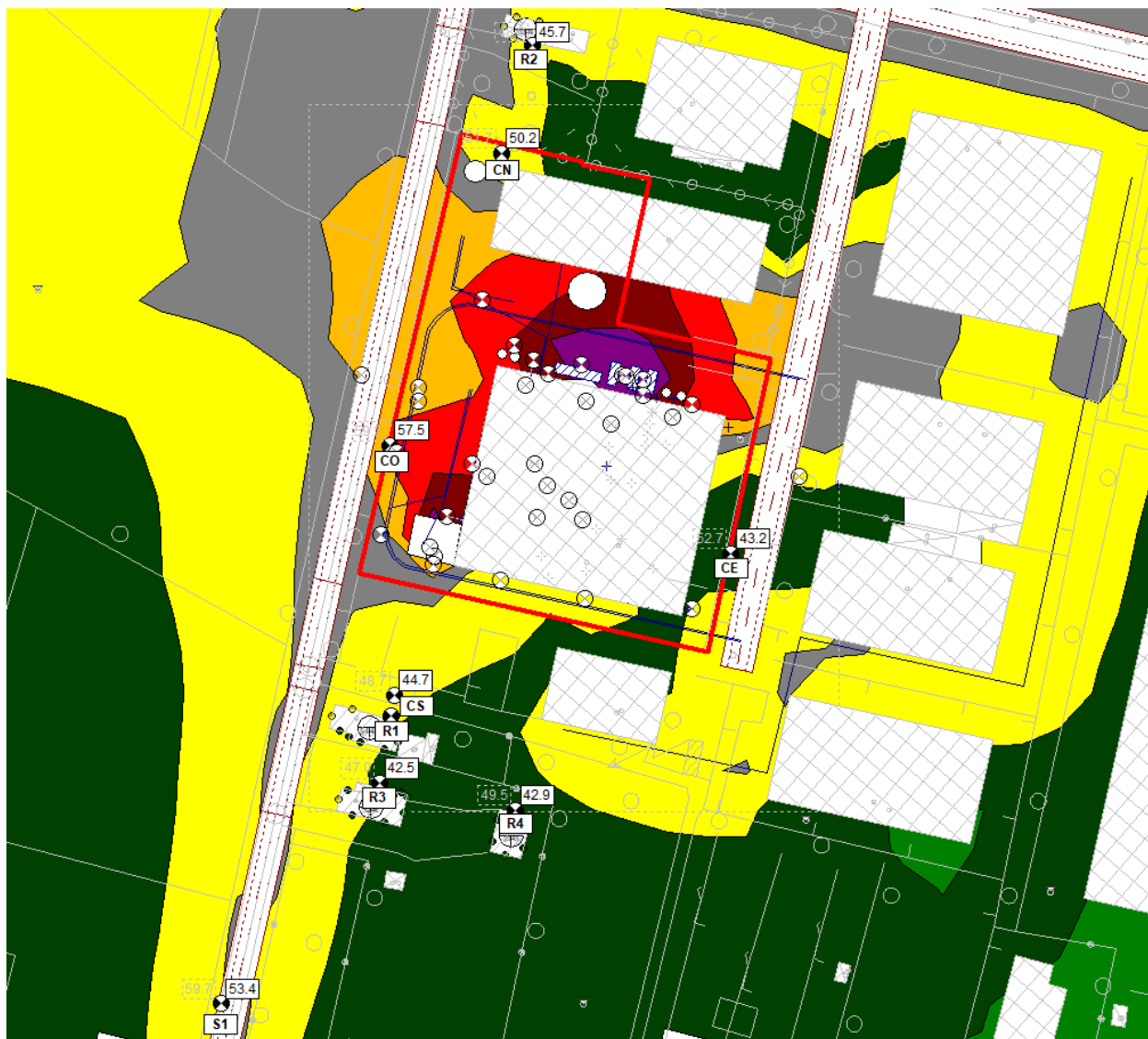
Figura 10-4 – Diffusione dei livelli acustici ambientali L_A nel periodo di riferimento notturno allo stato di progetto
