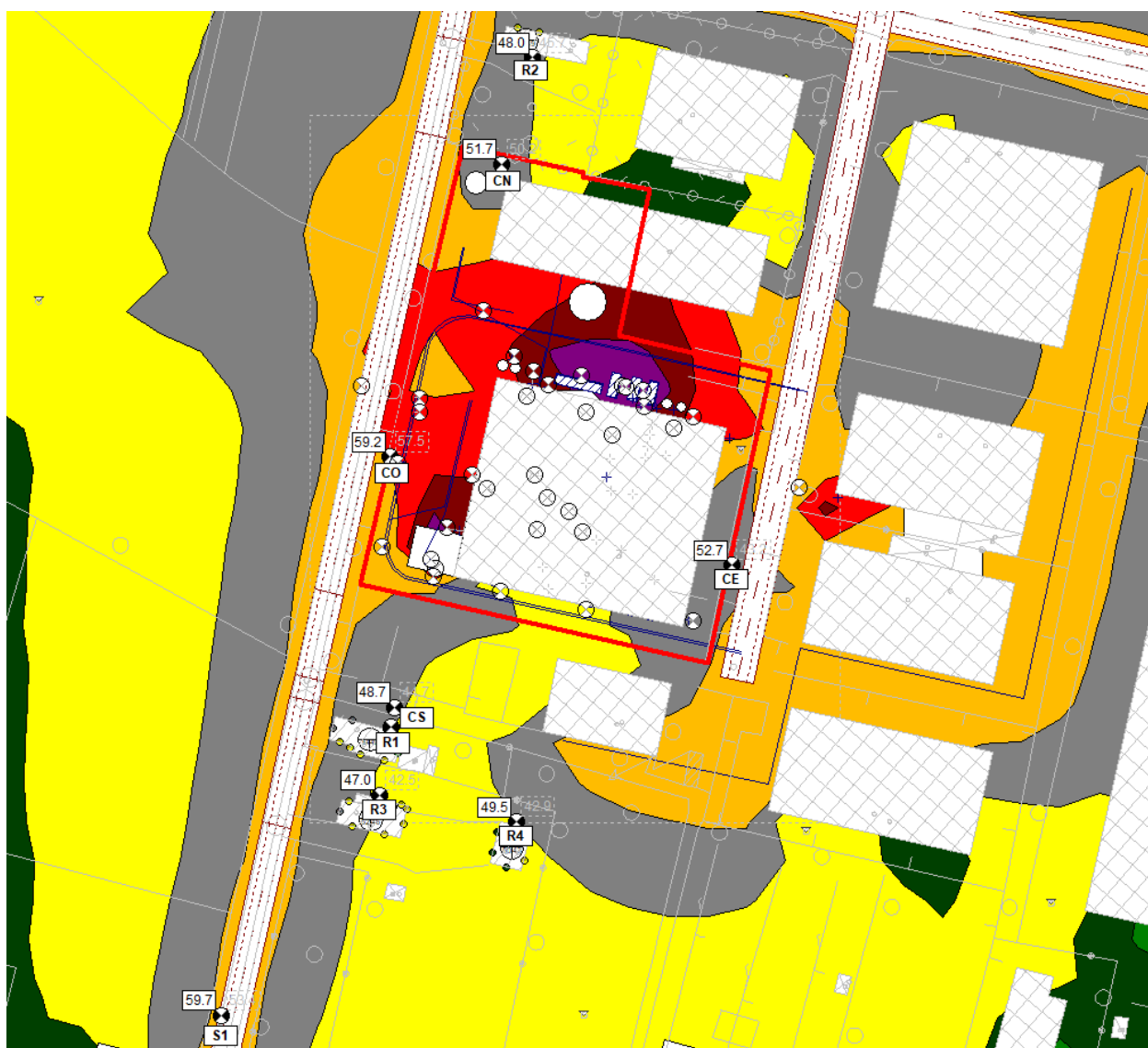
Figura 10-3 – Diffusione dei livelli acustici ambientali L_A nel periodo di riferimento diurno allo stato di progetto
