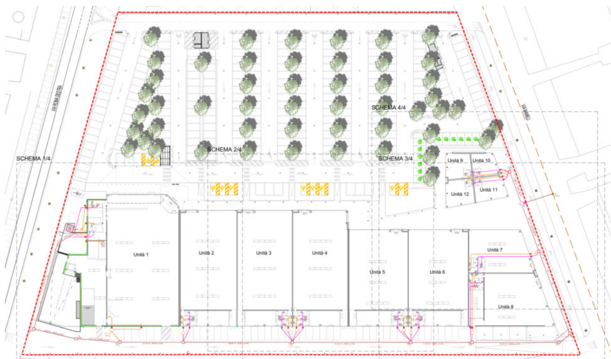
Figura 32 - Planimetria dello schema fognario delle acque grigie e nere.
