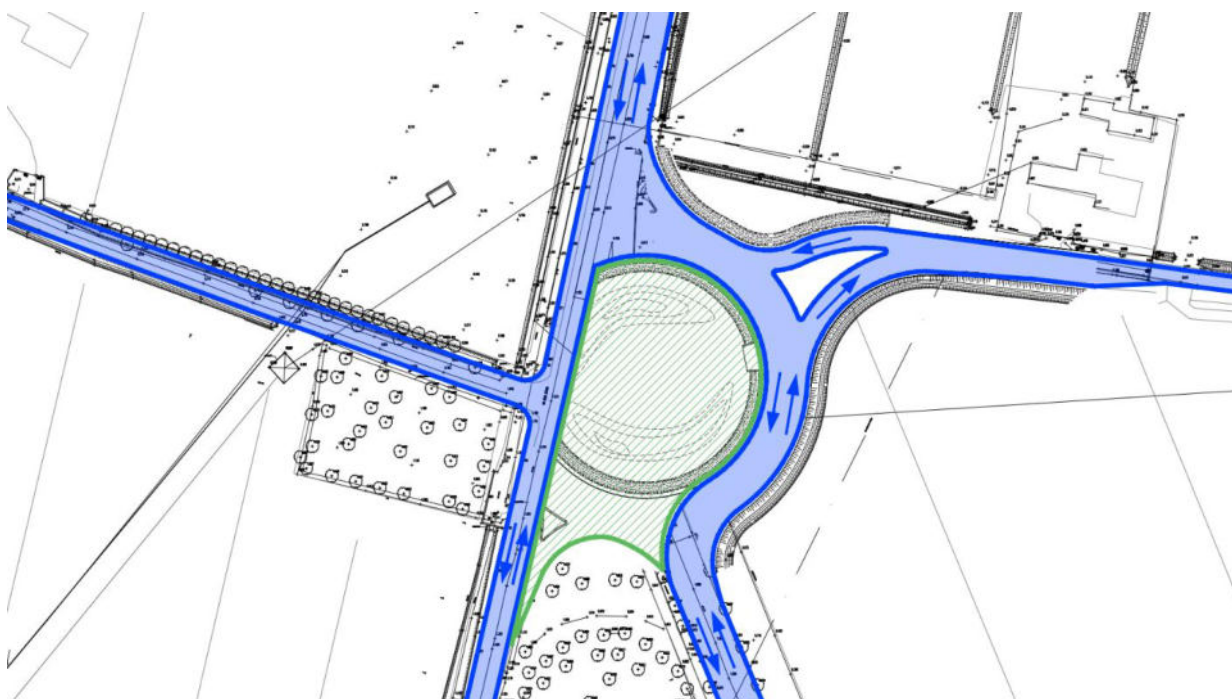
Figura 20 - Fase B.2 di cantiere (in verde); in blu la viabilità attività con i flussi di traffico.
