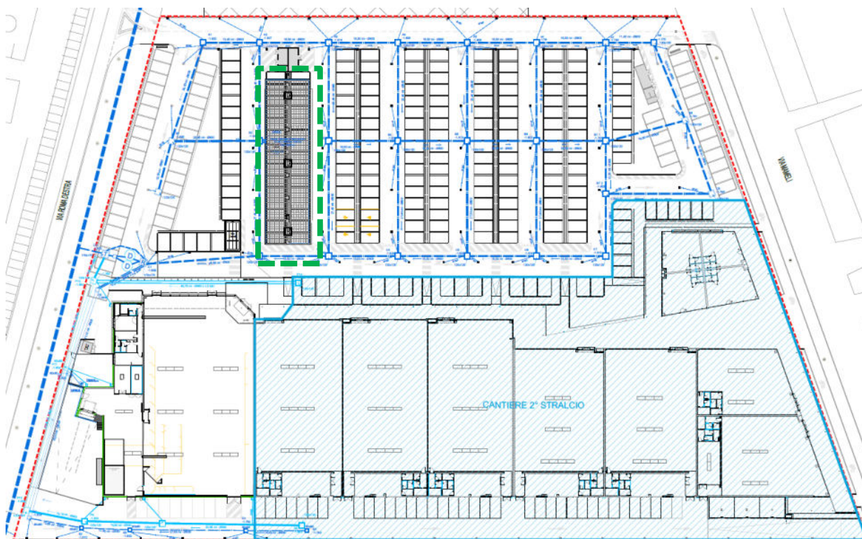
Figura 31 - Planimetria generale fognatura acque meteoriche; con linea tratteggiata verde è evidenziata la vasca di laminazione interrata, con linea blu è evidenziata la rete meteorica esistente mentre in azzurro la rete fognaria acque
