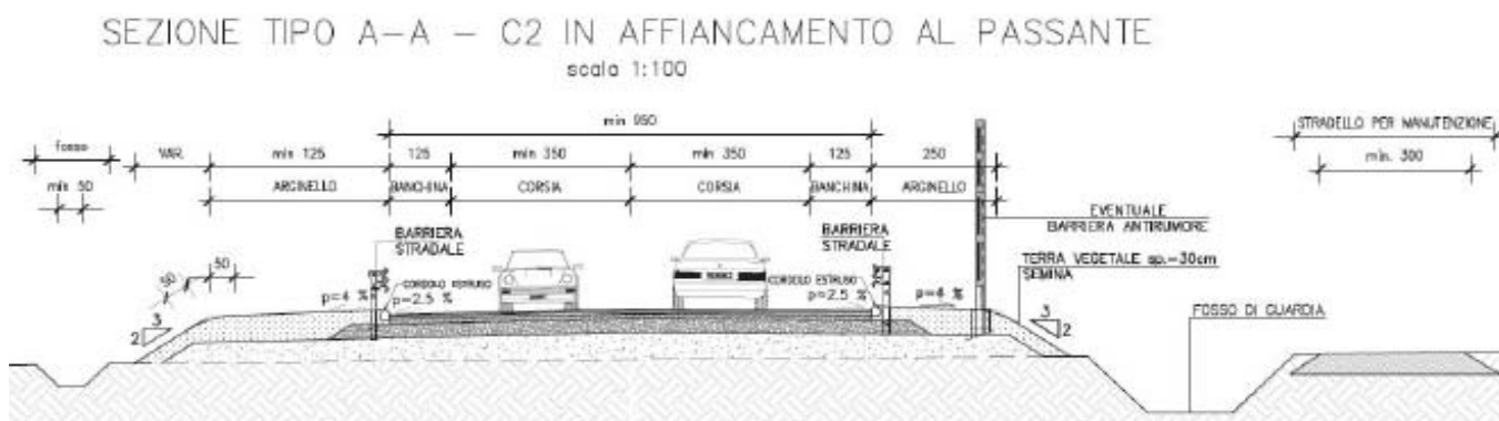
Figura 68 - Sezione tipo piattaforma C2 in affiancamento al passante
