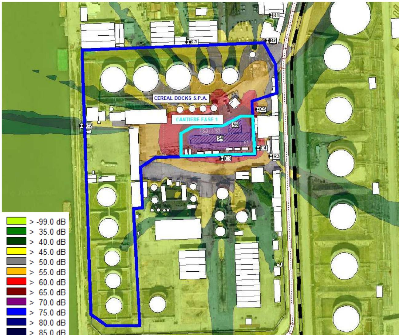
Figura 5-6. Cantiere est – Via Banchina Righi – Emissione acustica diurna nel tempo di riferimento per la fase di cantiere realizzazione fosse di trivellazione e opere di connessione
