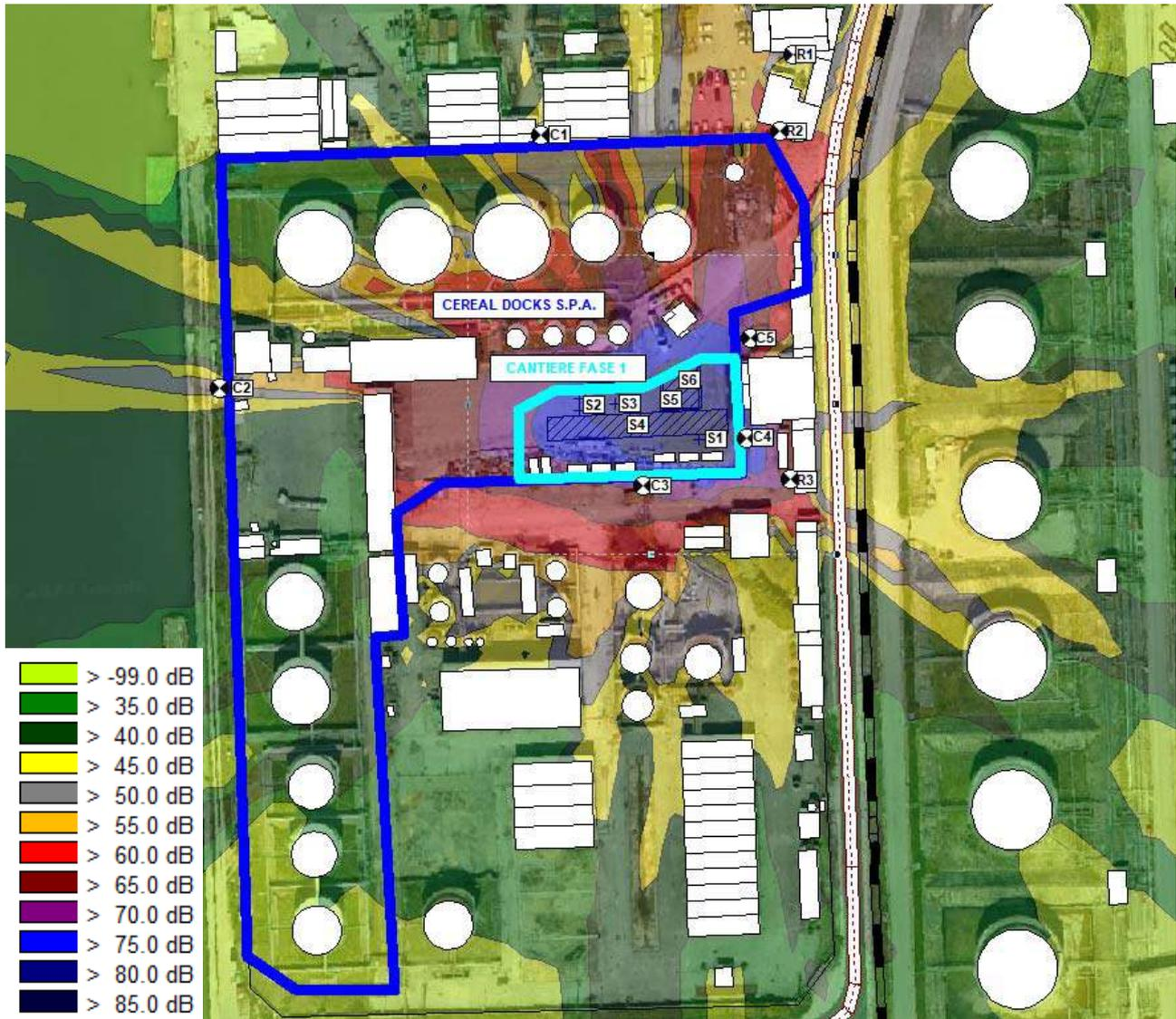
Figura 5-13. Cantiere est - Via Banchina Righi - Emissione acustica diurna nel tempo di riferimento per la fase di cantiere realizzazione TOC
