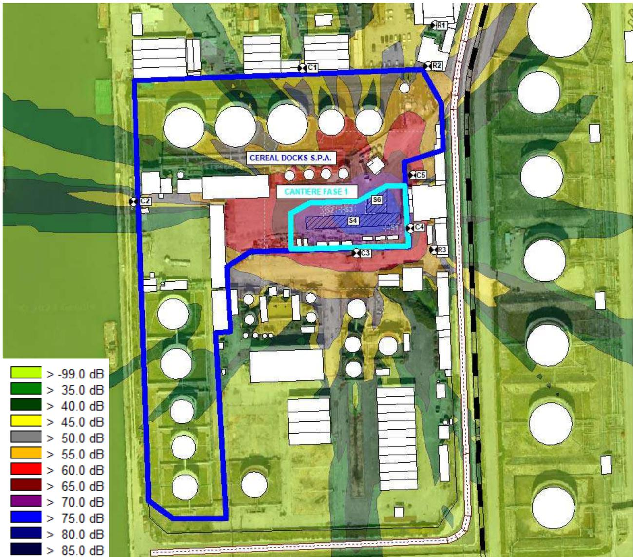
Figura 5-8. Cantiere est – Via Banchina Righi – Emissione acustica diurna nel tempo di misura di 30 minuti per la fase di cantiere realizzazione fosse di trivellazione e opere di connessione
