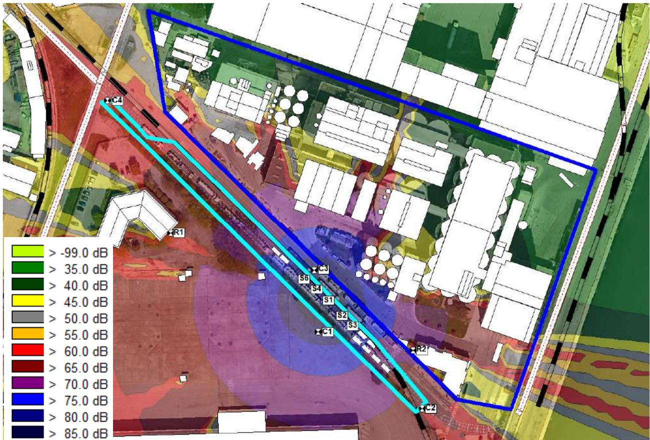
Figura 5-14. Cantiere ovest - Via Banchina dei Molini - Emissione acustica diurna nel tempo di misura di 30 minuti per la fase di cantiere realizzazione TOC
