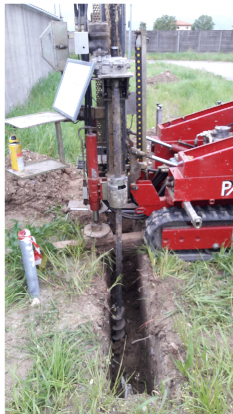
prova CPT F4 e preforo F1
