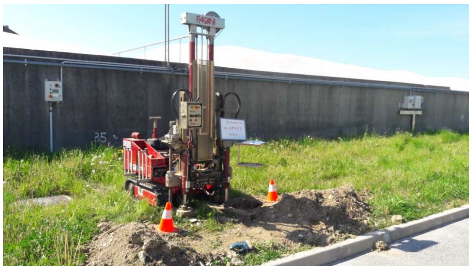
Esecuzione prova CPT F3 con prefondo in trincea su terre compatte.
