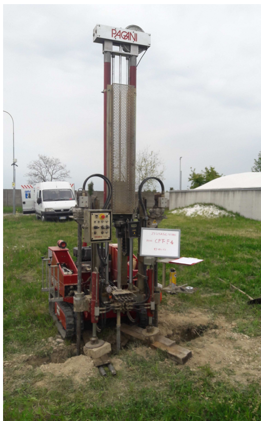
prova CPT F4 e preforo F1
