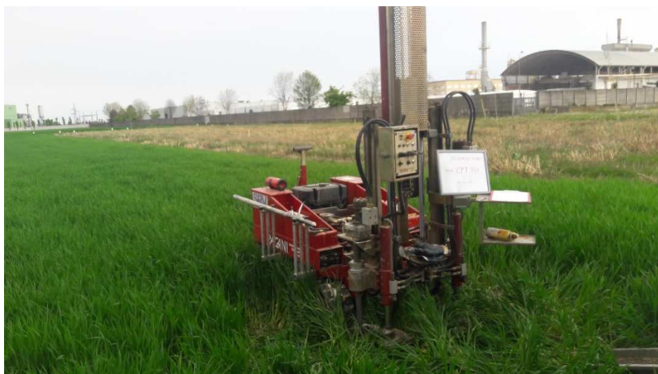
Esecuzione prova CPT RN1 su terreno naturale.
