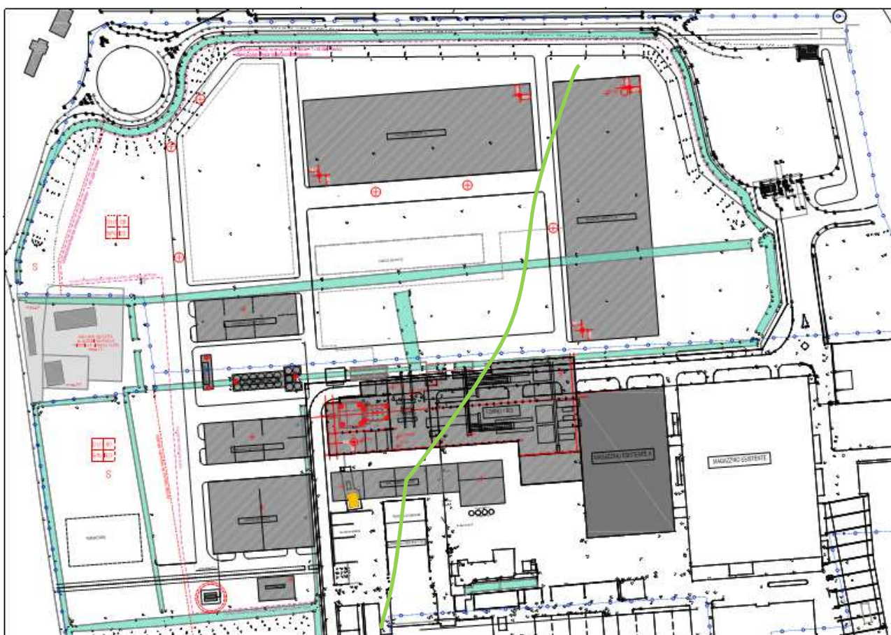
Figura 4 – VISTA PLANIMETRICA INTERVENTI PREVISTI E TERMINAZIONE DEL BANCO DI GHIAIA NEL SOTTOSUOLO (linea verde)
