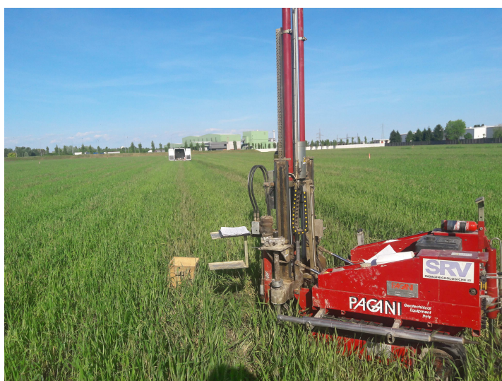
prova CPT V4
