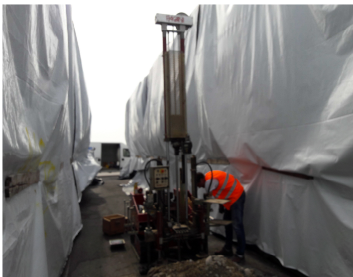
prova CPT MG2 e pre-foro su piazzale asfaltato
