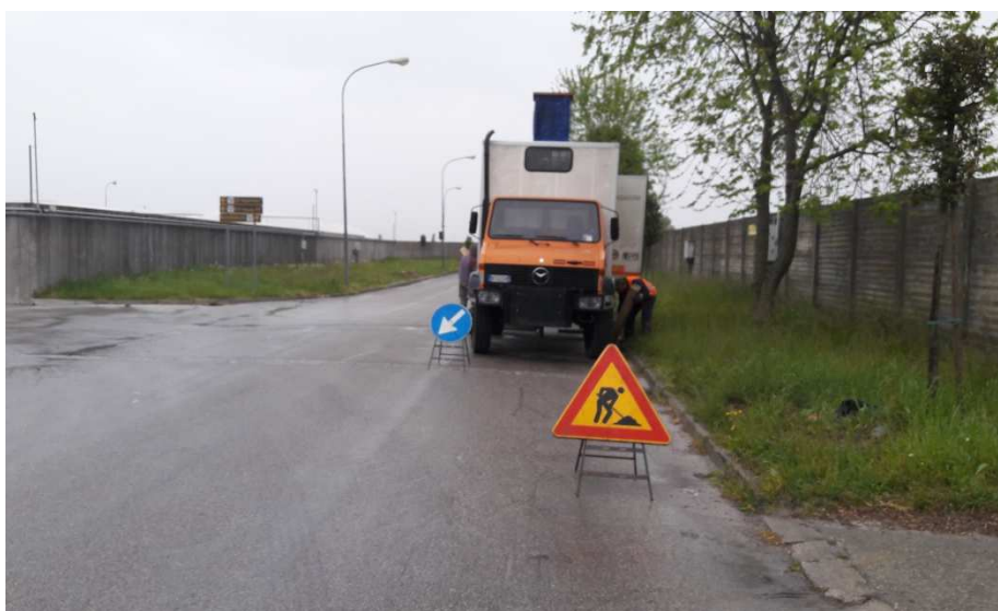
Esecuzione prova CPTU FB con preforo su asfalto.
