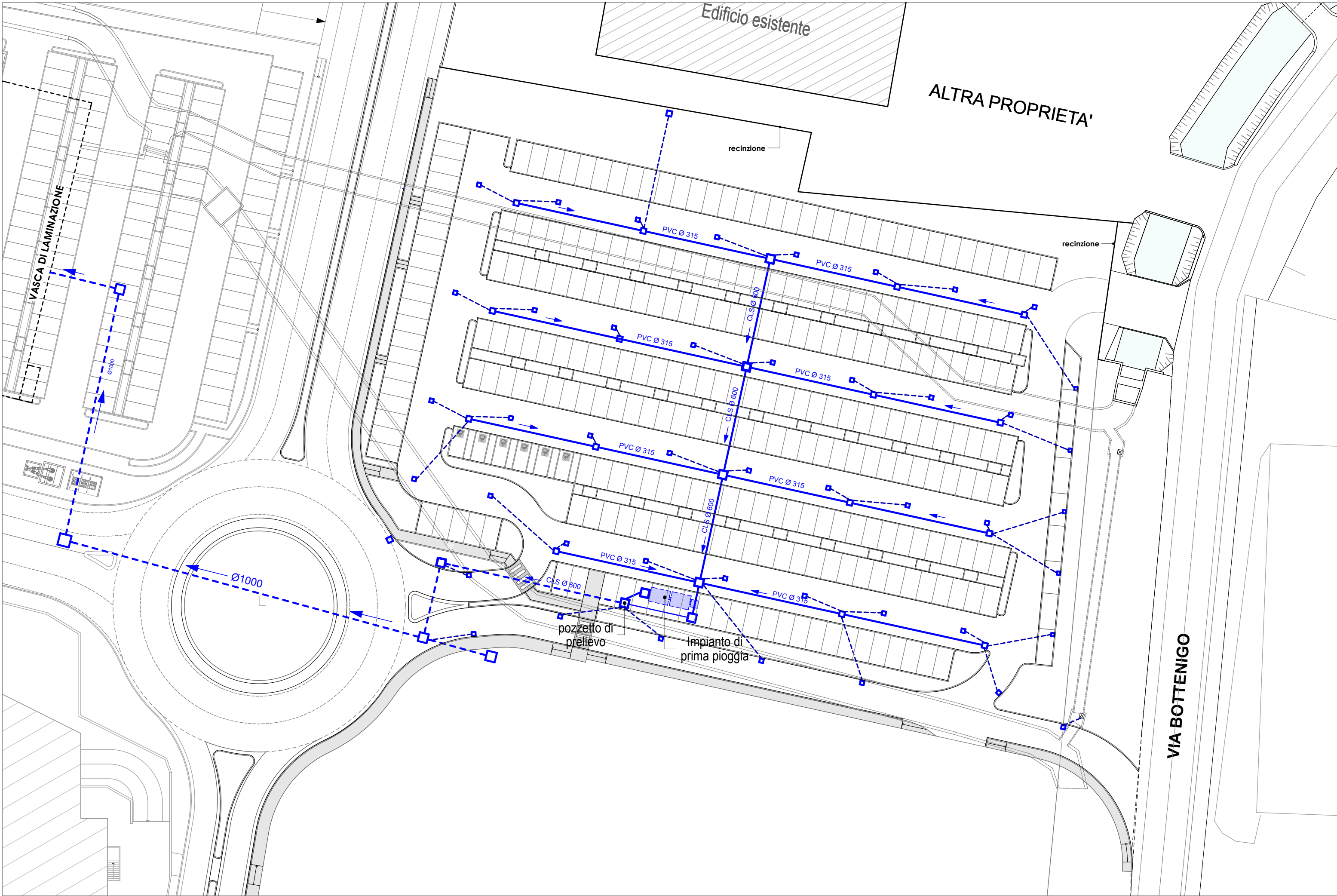
PLANIMETRIA PARCHEGGIO SCHEMA ACQUE BIANCHE REALIZZATA - SC. 1:500
