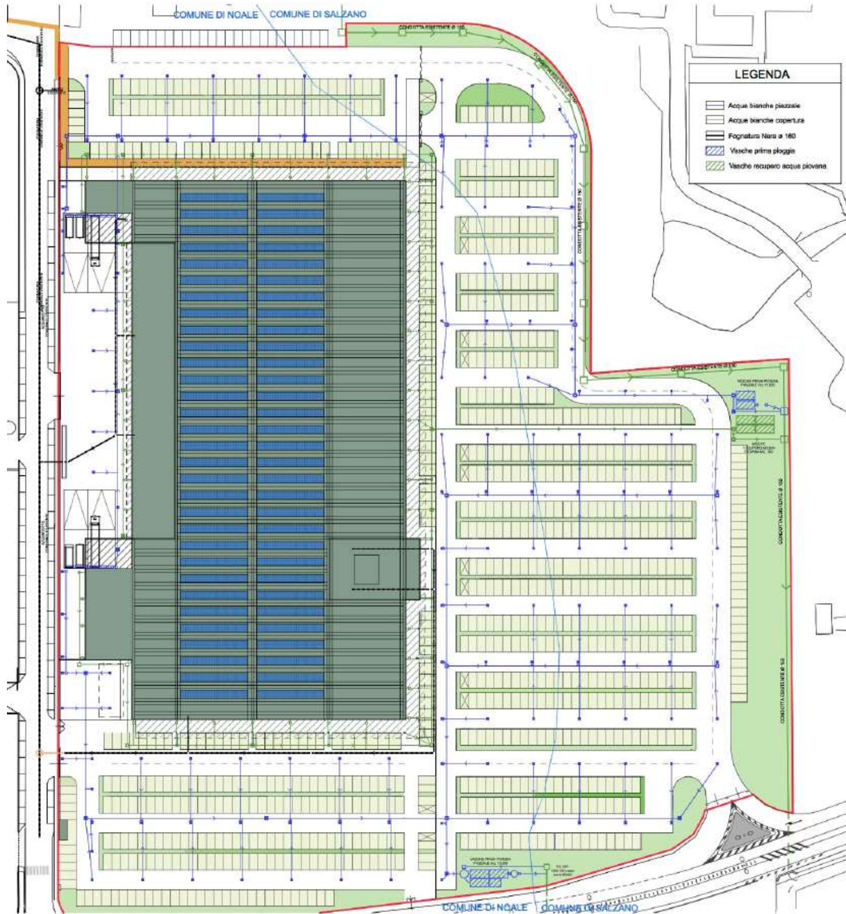
Figura 4.5 – reti di fognatura bianca e nera
