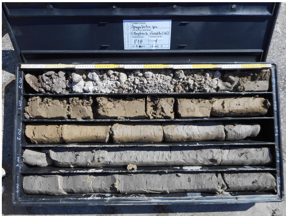
Sondaggio P18: cassetta n° 1, da 0.00 m a 5.00 m.
