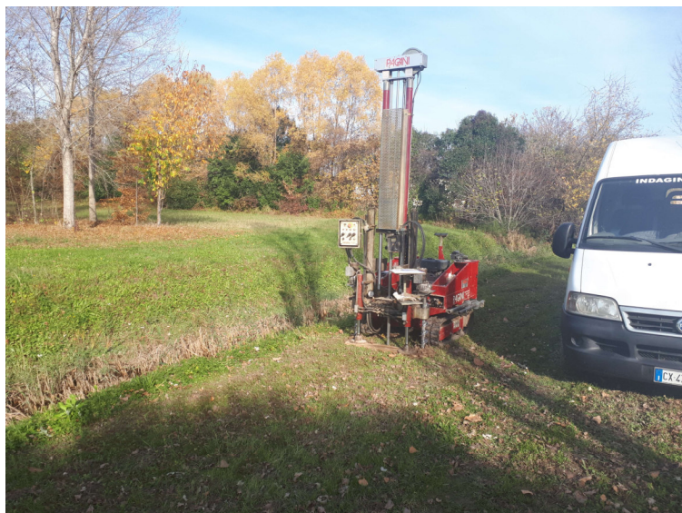
Alcune fasi dell'esecuzione della prova in sito CPT 1 – PONTILE IN SCATOLARE C.AV.
