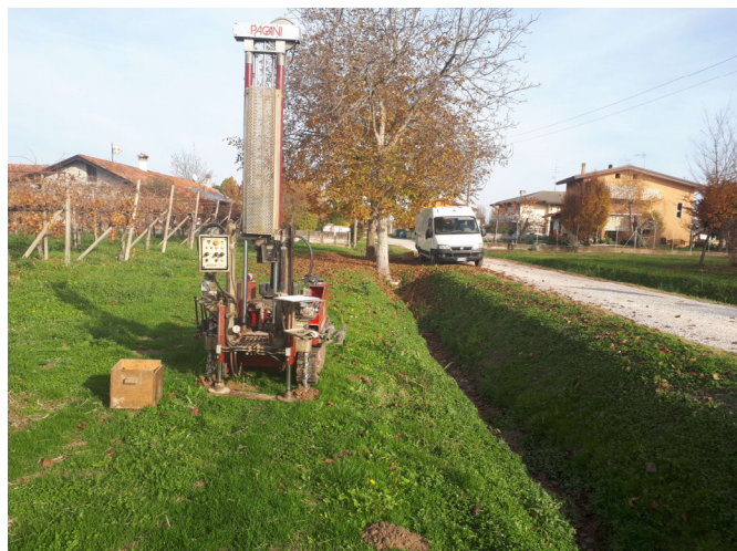
Alcune fasi dell'esecuzione della prova in sito CPT 2 – PONTILE B.
