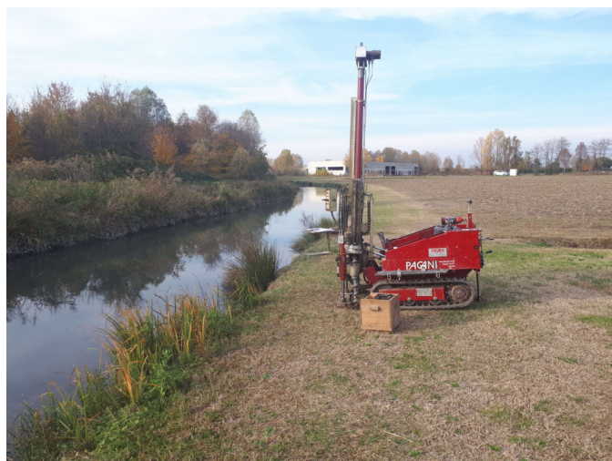
Alcune fasi dell'esecuzione della prova in sito CPT 3 – PASSERELLA A.
