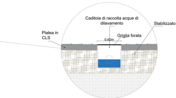
**Dettaglio Pacchetto Impermeabilizzato**
